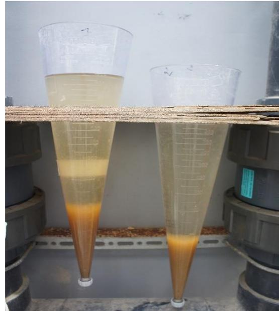
**Figure 1.** Mesure du volume de floc avec les cônes Imhoff
